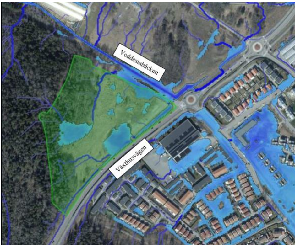
Figur 5-1 Befintliga flödesvägar och lågpunkter inom detalplaneområdet Orbacka C. Figur framställd i SCALGO Live och hämtad ur Dagvattenutredning för detaljplan Orbacka C, Geosigma 2022-06-03
