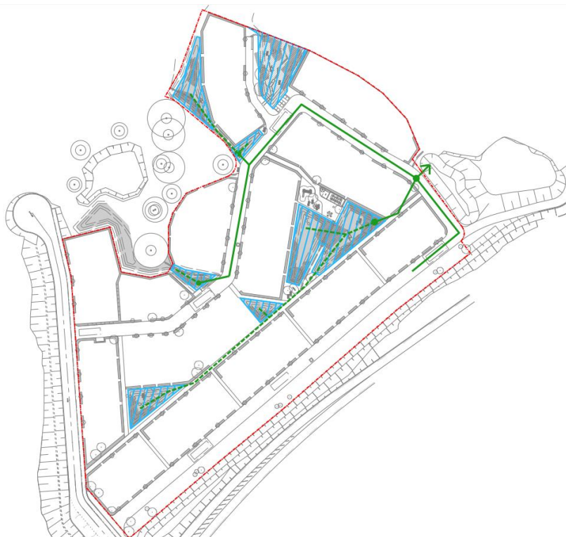
Figur 8-1 Torrdammar och princip för ledningsförläggningar inom kvartersmarken.
