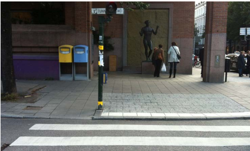
Bild 24 Övergångsställe enligt typritning TH0102, Stockholmsmodellen.
