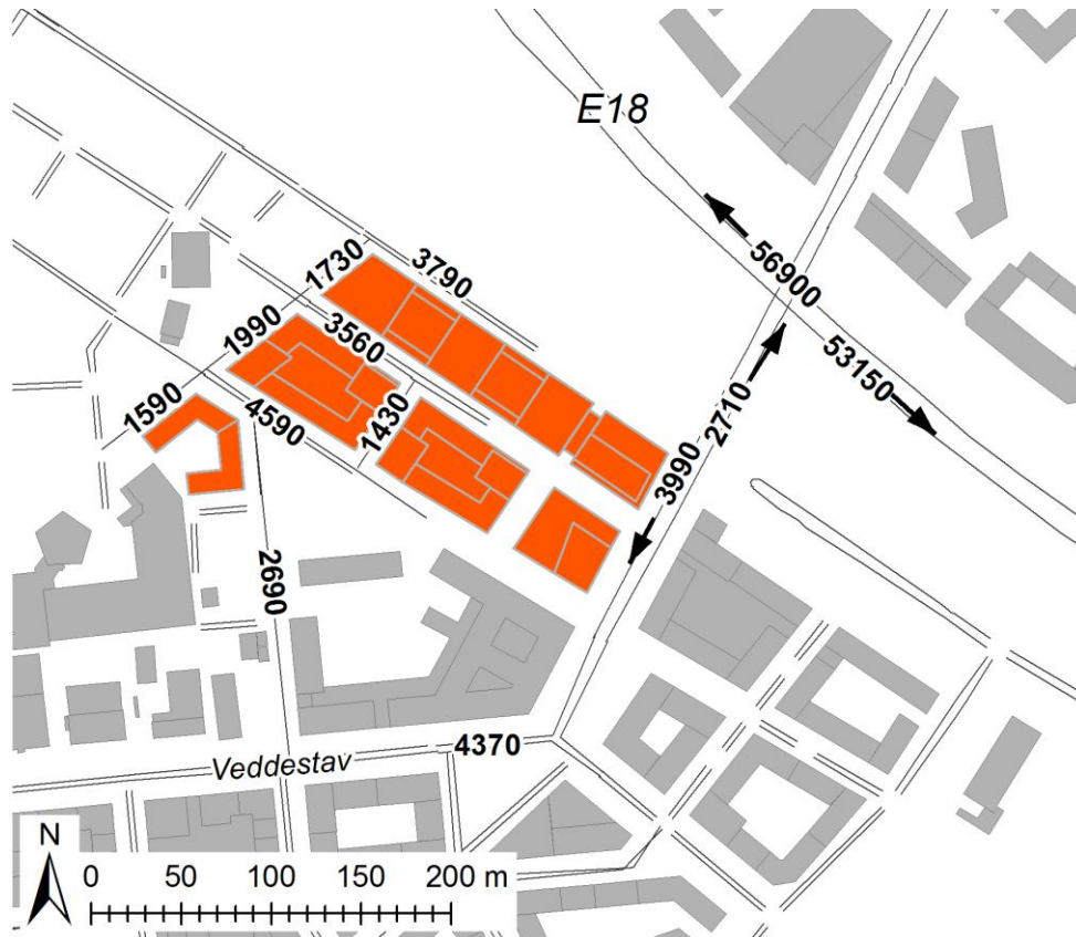
Figur 3. Trafikflöden som antal fordon per årsmedeldygn enligt prognos för år 2040. Pilarna anger trafikriktningen. Byggnader planerade i Veddesta etapp III visas med orange färg. Fler trafikflöden för området finns i bilaga 1.
