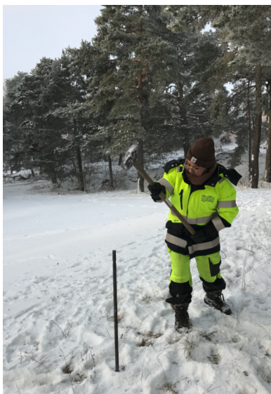
Figur 1 Marken var under provtagningstillfället täckt av snö. Bild till vänster visar förberedelse för mätning av radonhalt i mark. Bild till höger visar mätning av gammastrålning med gammamätare och gammaspektrometer.
