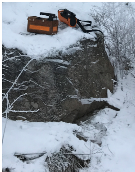
Figur 1 Marken var under provtagningstillfället täckt av snö. Bild till vänster visar förberedelse för mätning av radonhalt i mark. Bild till höger visar mätning av gammastrålning med gammamätare och gammaspektrometer.
