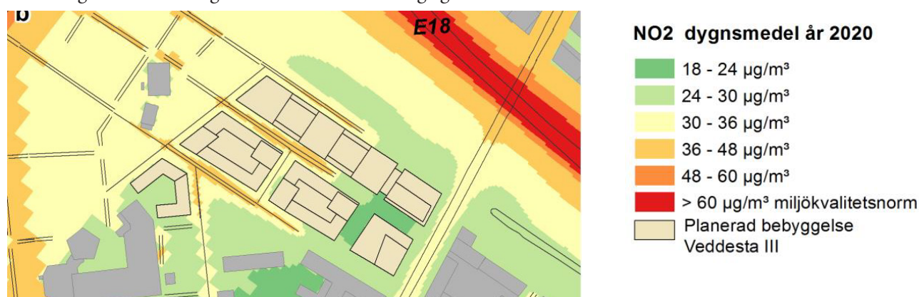
Figur 11. Beräknade dygnsmedelhalter av kvävedioxid år 2020. Lokala gaturum riskerar att ha något förhöjda värden men riktvärden klaras för hela området (SLB-analys, 2019).
