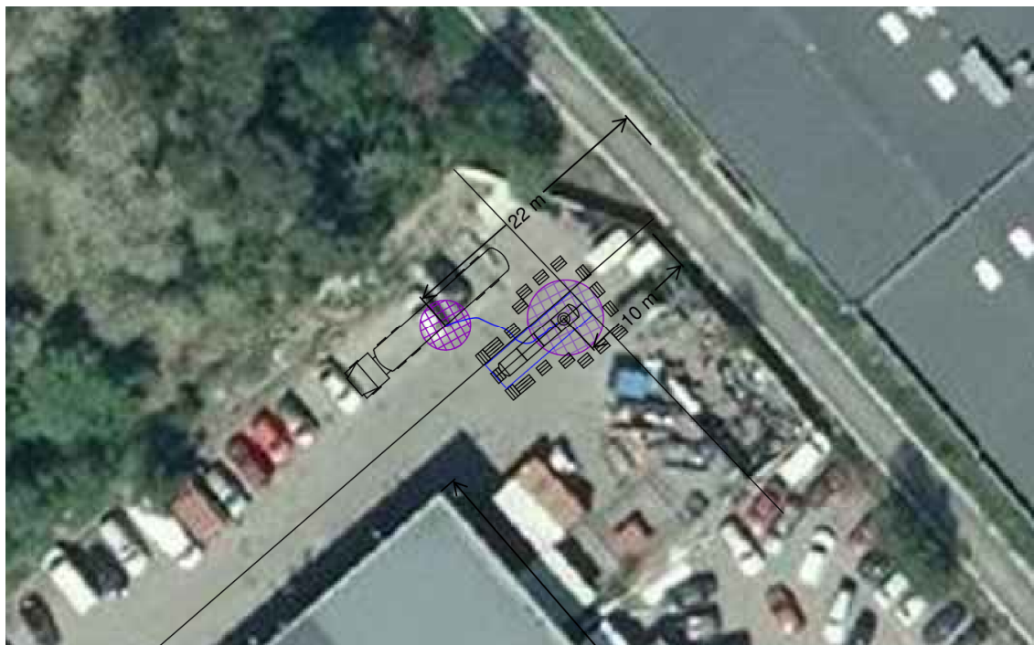
Figur 5. Placering av gasolcistern och tankfordonsplacering inom MTO:s område. Observera att måttangivelserna är ungefärliga då tillgängligt underlag inte redovisar aktuell skala.
