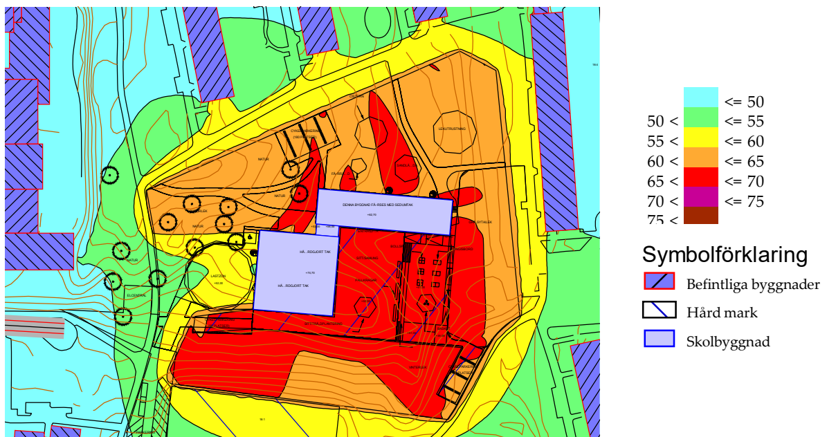
Figur 19: Simulering från bullerutredning som visar ekvivalent ljudnivå från uppskattad lek inom planområdet efter utbyggd exploatering. (Akustikbyrån 2019)
