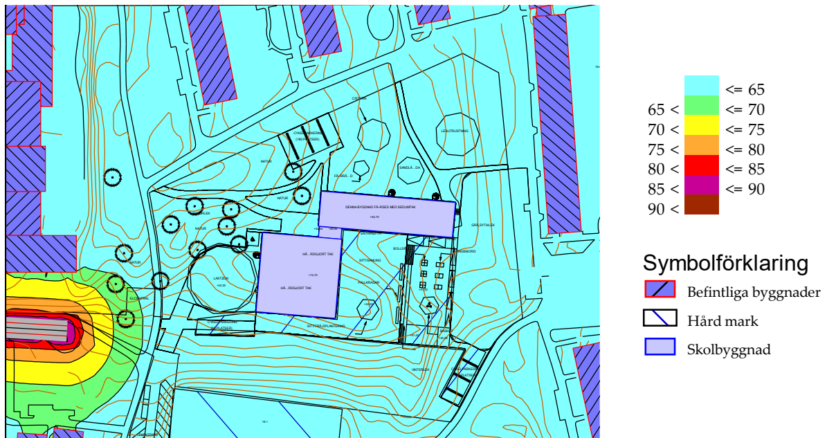
Figur 18: Simulering från bullerutredning som visar maximal ljudnivå från uppskattad trafik inom planområdet efter utbyggd exploatering. (Akustikbyrån 2019)
