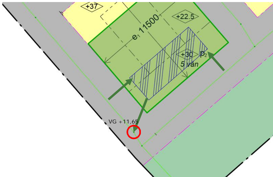
Figur 31. Principskiss av kassettmagasin. Gröna pilar symboliserar in- och utlopp. Röd cirkel visar anslutningspunkt för utlopp (VG +11,65).
