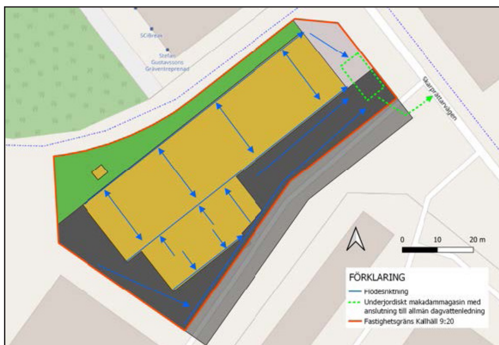
Bild över föreslaget dagvattensystem där hela fastighetens avrinning leds till ett underjordiskt makadammagasin. (Geoveta, 2021).
